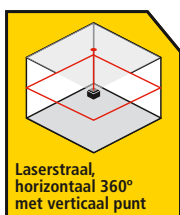
Laserstraal met horizontale rotatie van 360°
